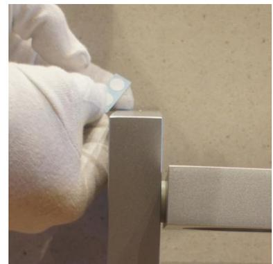
Decken Sie anschließend - sofern gewünscht - die Verschraubungen mit den Zierpunkten ab.
