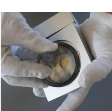
Handhabung der Linsen: Die Leuchte besitzt zwei innenliegende Magnete, welche die Linsen- oder Filter tragen. Für den korrekten Halt muss auf jeder Seite jeweils eine Linse oder Filter mit Metallring eingebaut sein. Mit dem beiliegenden Saugnapf können Linsen oder Filter gewechselt werden.
